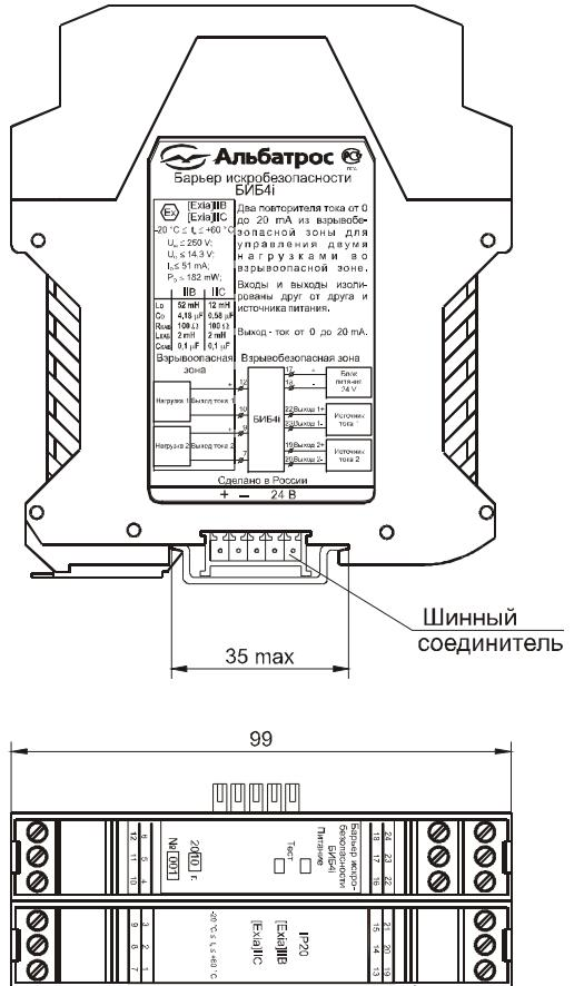
Рисунок 1 – Габаритные размеры приборов
