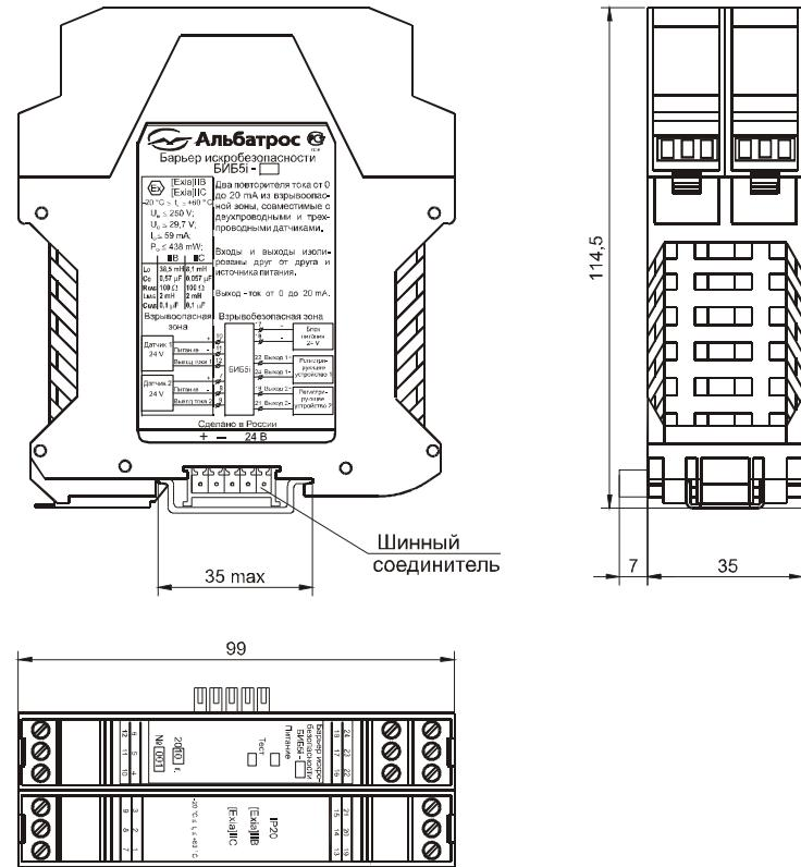
Рисунок 1 – Габаритные размеры приборов
