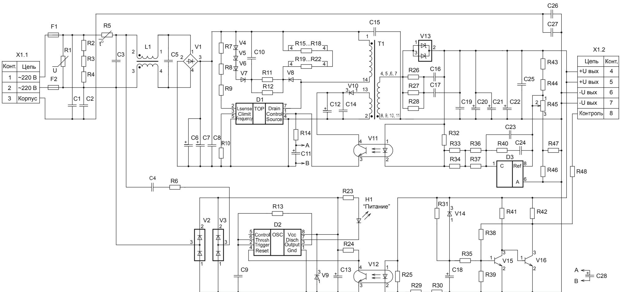
1. Разъем X1 конструктивно образован из клеммников FRONT 2,5-H/SA 5 KMGY Phoenix Contact Gmb H & Co.
