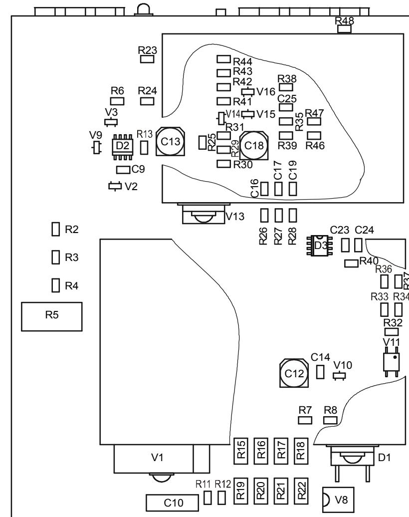
Рисунок В.2 – Расположение элементов на плате прибора
