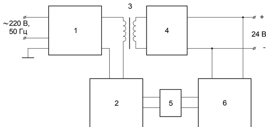
Рисунок 1 – Структурная схема прибора
