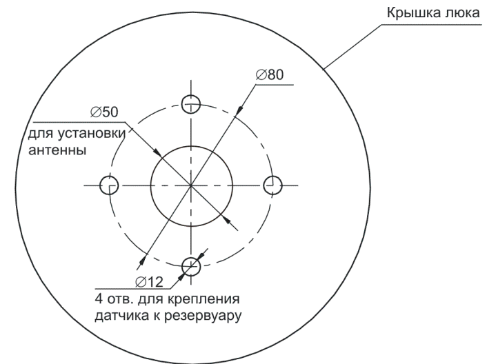
Рисунок 2 – Рекомендуемый вариант посадочного места датчиков РДУ1-0(0А, 1, 1А, 2, 2А) на резервуаре
