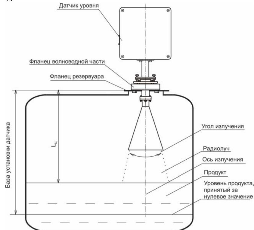
Рисунок 1 – Внешний вид датчика РДУ1-0(0A, 1, 1A, 2, 2A) на резервуаре
