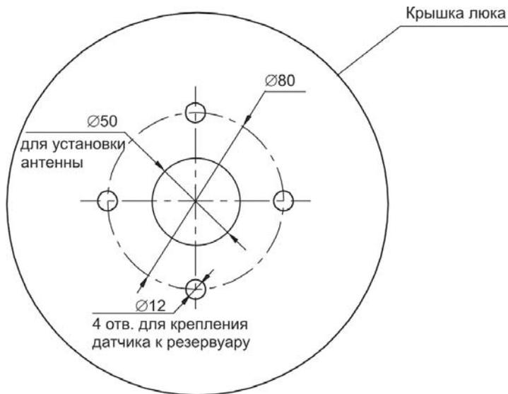
Рисунок 2 – Рекомендуемый вариант посадочного места датчиков РДУ1-0(0А, 1, 1А, 2, 2А), РДУ3-00(01, 10, 20) на резервуаре
