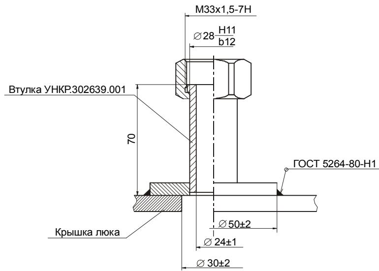
Рисунок 7 - Рекомендуемый вариант посадочного места датчиков УТР1 на резервуаре
