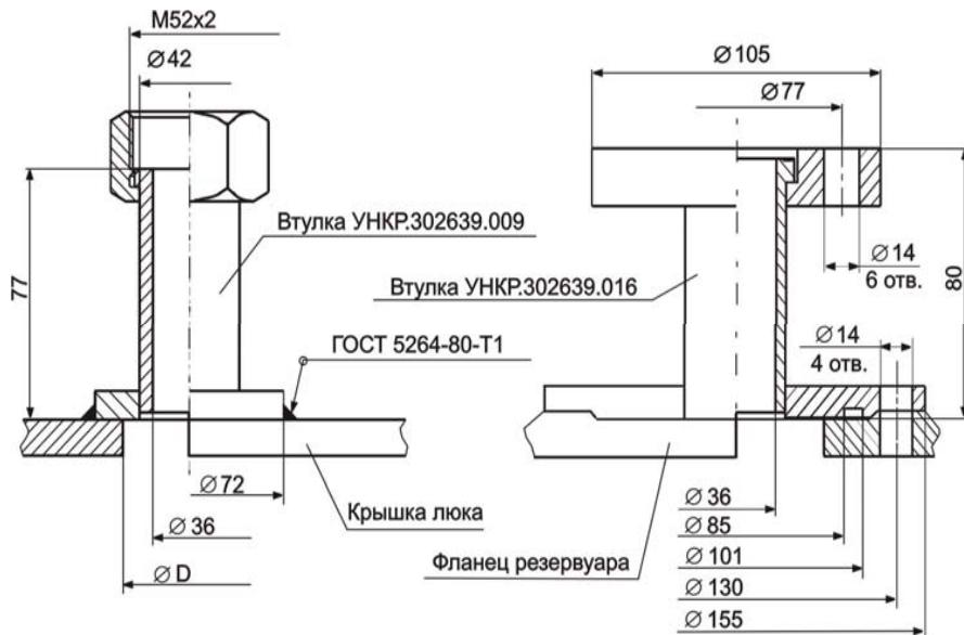
Примечание – Диаметр отверстия в крышке люка D должен быть в интервале от 38 до 55 мм.
