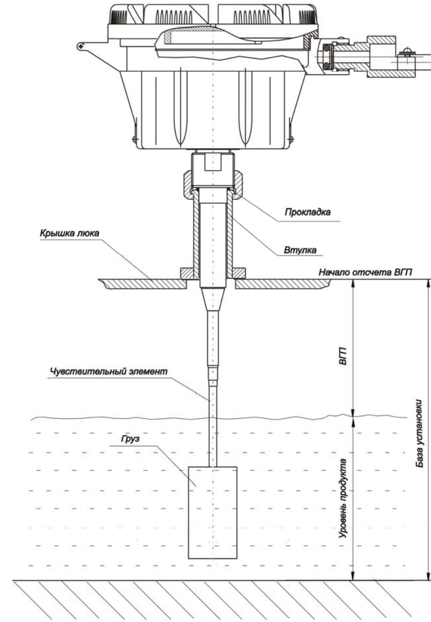
Рисунок 6 – Внешний вид датчика УТР1 на резервуаре
