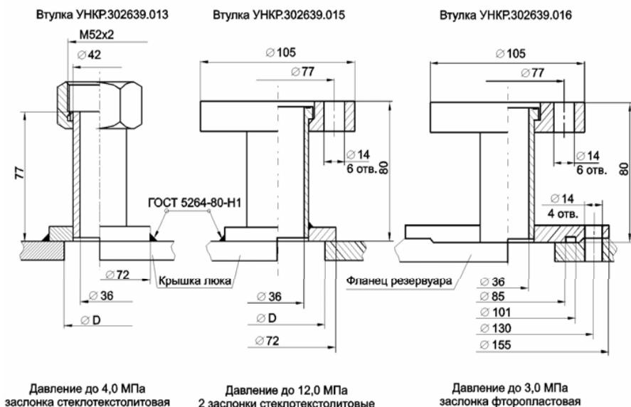
Примечание – Диаметр отверстия в крышке люка D должен быть в интервале от 38 до 55 мм.
