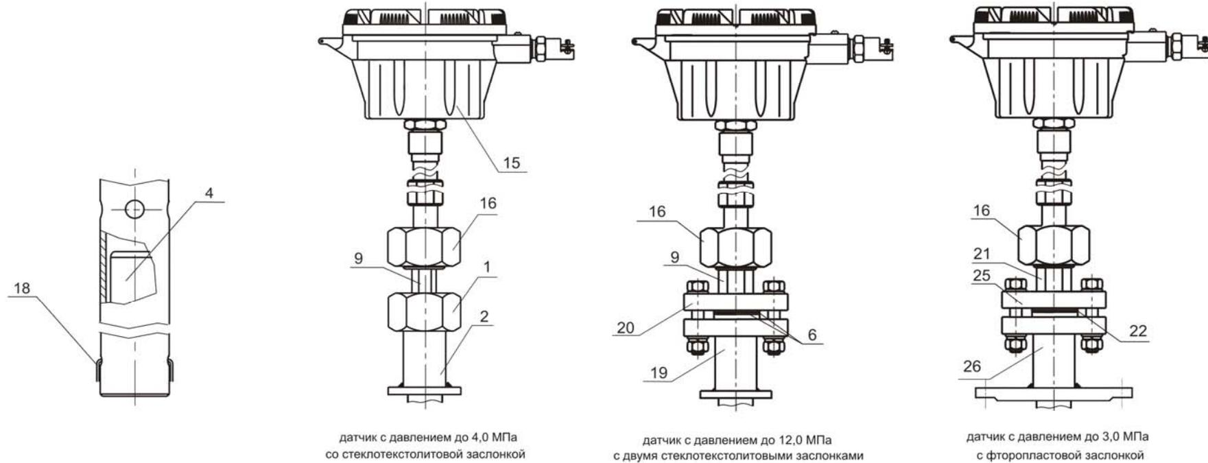
Рис. Н.2 - Конец волновода с поплавком
