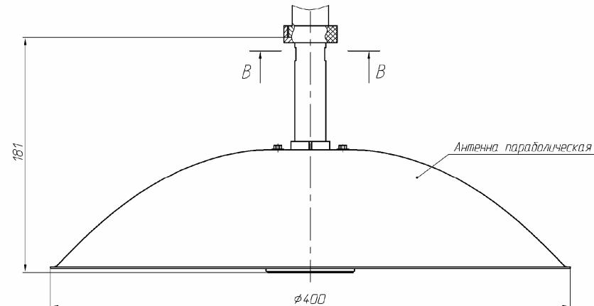
Рисунок С.1 – Габаритные и установочные размеры датчиков РДУЗ (лист 1)
