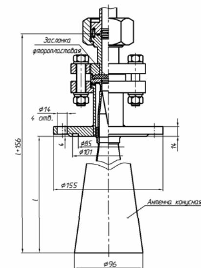
Рисунок С.1 – Габаритные и установочные размеры датчиков РДУЗ (лист 4)
