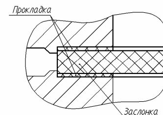
При монтаже на емкости смещение прокладок, кольца, заслонки относительно посадочного места фланцев не допускается.
