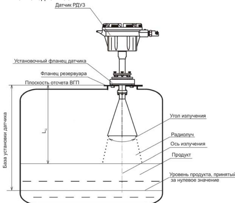
Рисунок 4 – Внешний вид датчика РДУЗ-00(01, 10, 20) на резервуаре
