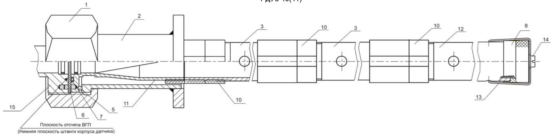
Рис. Н.1 - Вид собранного волновода датчика РДУЗ-30 с нагрузкой и заслонкой (увеличенено, повернуто)
